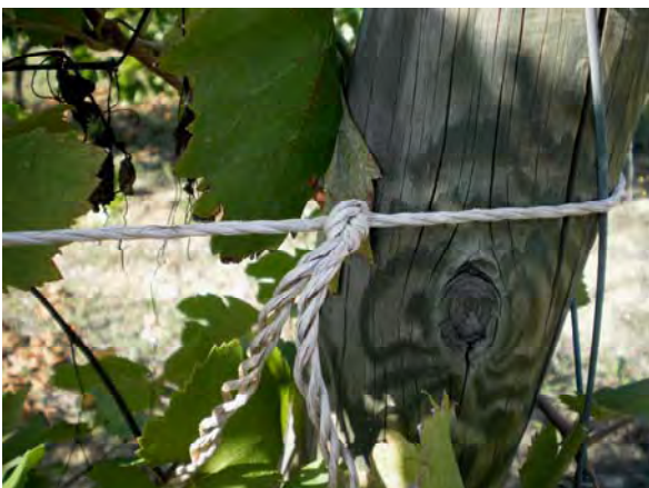
Foto 2: Il cordoncino annodato sul palo di testa dopo un'estate intera non rivela ancora segni di debolezza
